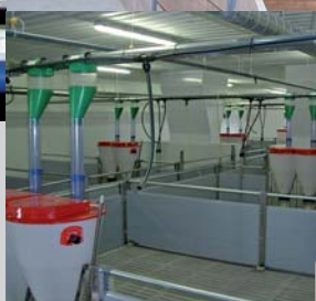
Aufnahmestation ◀ mit Dosierschnecke
